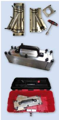
Y-Stück mit Adapterstücken für Rohr-DA 40, 50 und 63 mm im Koffer.
