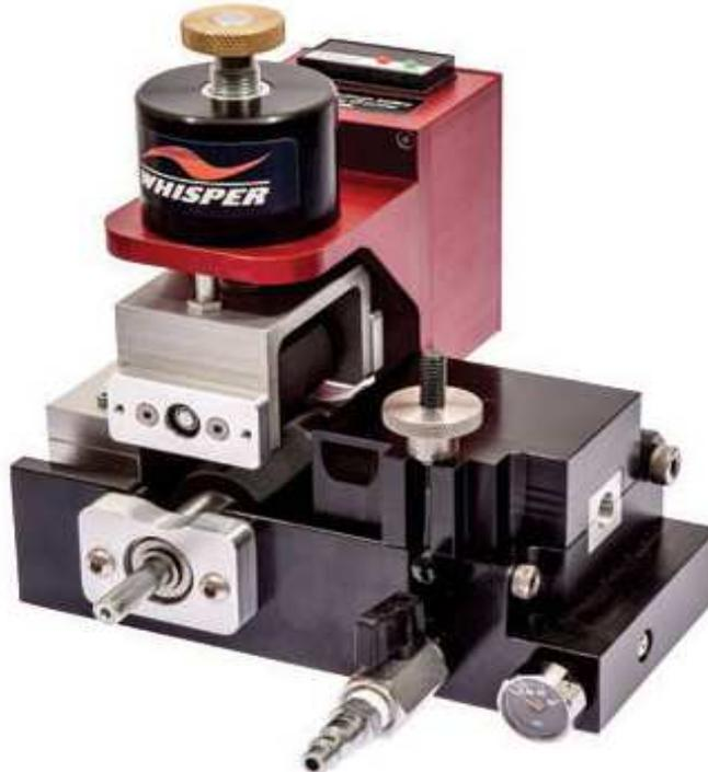
Das Whisper Kabeleinblasgerät wurde gestaltet, um ein kompaktes tragbares Kabelinstallationssystem zu bieten können. Einfache Bauteiländerungen erlauben das Einführen verschiedener Kabelgrößen in bereits gelegte Mikrokanäle. Das Kabel wird von einem Akkuschrauber bewegt und ein elektronischer üblicher Bildschirm bietet Auskunft über die Geschwindigkeit des einzuführendem Kabels sowie die Distanz welche das Einführojekt bereits zurückgelegt hat. Empfehlende Kompressor: C-COMP-15
