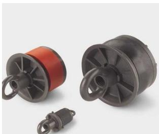
Rohr-Dichtstopfen mit Ösenschraube zum Abdichten von leeren Rohren gegen Eindringen von Wasser und Schlamm vor der Kabelverlegung. Ganz Kunststoffausführung, korrosionsfest. Wasser- und Luftdicht bis 0,5 bar (5 m Wassersäule). Einfaches Einsetzen und Entfernen von Hand, wiederverwendbar.
