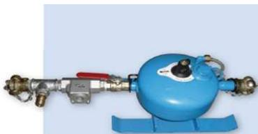
Der Nebelöler wird zwischen Kompressor und Einblaskopf montiert und versorgt den Luftstrom mit einem Kabelgleitmittel zur Reduzierung der Reibung zwischen Kabel und Schutzrohr. Das Gerät ist mit einer Fein-Dosiereinrichtung ausgerüstet und arbeitet nach dem Injektorprinzip. Im Lieferumfang ist je ein Verbindungsschlauch zum Einblaskopf und zum "CABLE FEEDER" enthalten.
