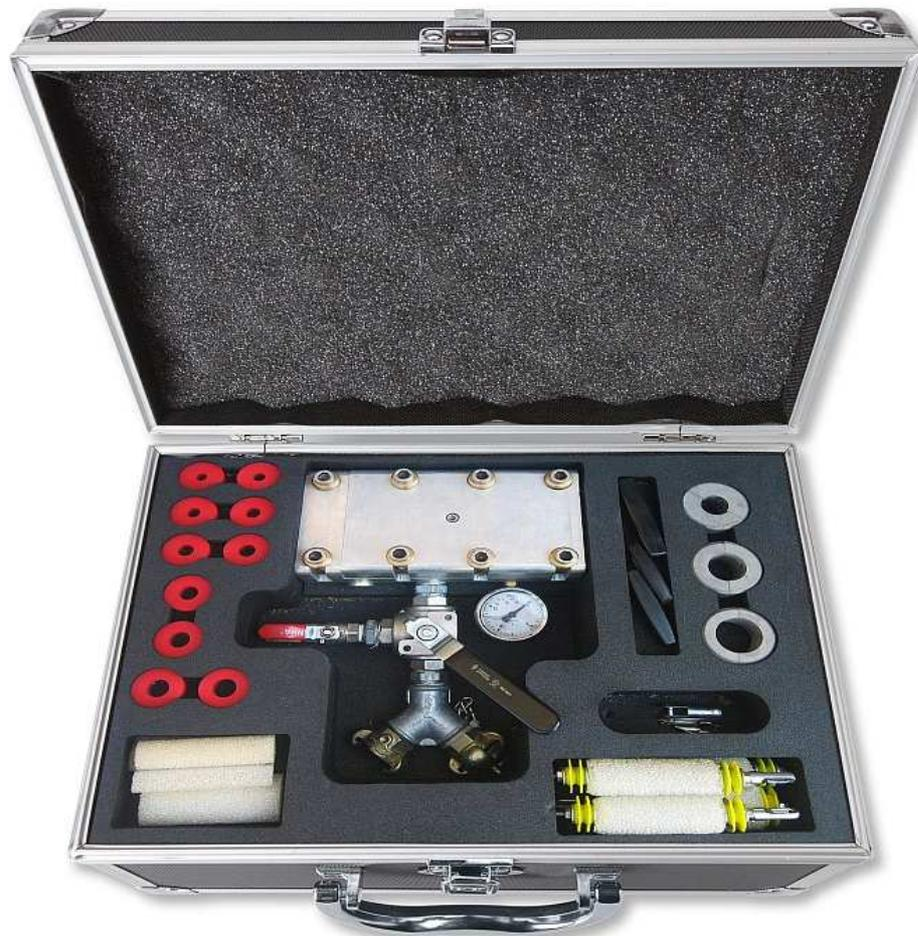
Das Basisgerät "VARIOJET" ist als eigenständige Einheit bereits voll für die Kabelverlegung geeignet (für Längen bis ca. 1000 m). Für den Betrieb des Variojet empfehlen wir einen Kompressor mit einem Arbeitsdruck von 10 bar und einer Fördermenge von 10 m<sup>3</sup>/min. Der Kompressor muss mit einem Nachkühler ausgerüstet sein. Die Einblasgeschwindigkeit beträgt bis zu 100 m/min.
