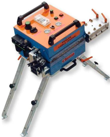
Der "CABLE FEEDER" dient zur Unterstützung des "VARIOJET" bei grossen Kabellängen bzw. schwierigem Trassenverlauf. Hierzu wird der Einblaskopf des "VARIOJET" am "CABLE FEEDER" montiert. Standardmässig wird der "CABLE FEEDER" ohne Einblaskopf, Messung und Untergestell geliefert (Bild mit Untergestell und Einblaskopf).
