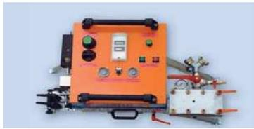
Längen- und Verlegegeschwindigkeitsmessung. Schlupfüberwachung mit automatischer Öffnung der Förderketten bei zu hohem Schlupf zwischen Kabel und Förderketten (um Beschädigungen des Kabels zu vermeiden).
