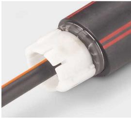
Rohr- und Kabel-Dichtstopfen für 1 LWL-Kabel. Geteilte Ausführung, völlig zerlegbar. Auch zum späteren Abdichten geeignet. Ganz Kunststoffausführung, korrosionsfest. Wasser- und luftdicht bis 0,5 bar (5 m Wassersäule). Einfaches Einsetzen und Entfernen von Hand, wiederverwendbar.
