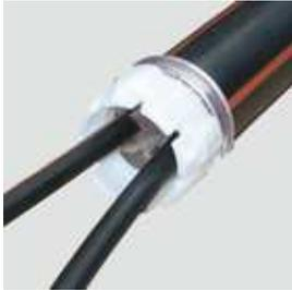
Rohr- und Kabel-Dichtstopfen für 2 LWL-Kabel. Geteilte Ausführung, völlig zerlegbar. Auch zum späteren Abdichten geeignet. Ganz Kunststoffausführung, korrosionsfest. Wasser- und luftdicht bis 0,5 bar (5 m Wassersäule). Einfaches Einsetzen und Entfernen von Hand, wiederverwendbar.
