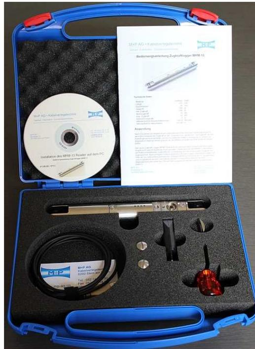
Der neue, hochpräzise Zugkraft-Logger MRM-13 wird direkt zwischen dem Zugseil und dem Kabel angebracht und mit durch das Rohr gezogen. Dabei zeichnet der MRM-13 die effektiv am Kabel entstehenden Zugkräfte auf, unabhängig von der abweichenden Zugkraft der Zugmaschine.
