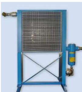
Der Druckluft-Nachkühler wird benötigt, wenn der verwendete Kompressor keine eigene Nachkühlung hat. Zur Ausstattung gehört ein Wasserabscheider sowie ein elektrischer Lüfter (Stromanschluss 230V, Einphasen-Wechselstrom)
